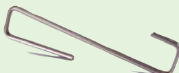
Ganci fermacoppo sez. 2 x 3,4 mm acciaio inox brunito Conf. 400 pz mm 90 x 16 / mm 90 x 20 15 pz. / mq (coppi superiori) 22 pz. / mq (coppi sup. e controdocci)
